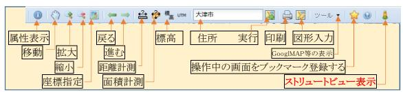
ストリュートビュー表示のアイ コンをクリックした後、表示し たい場所の道路をクリックす ると、その場所のストリュートビ ュー画像を表示させることが 出来ます。
